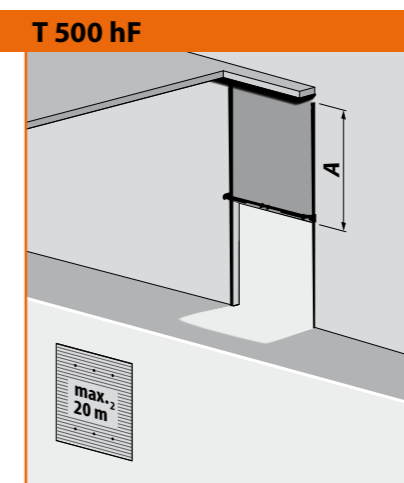
Pionowy system prowadnic z obniżonym wałem sprężynowym + stalowy profil wzmacniający
