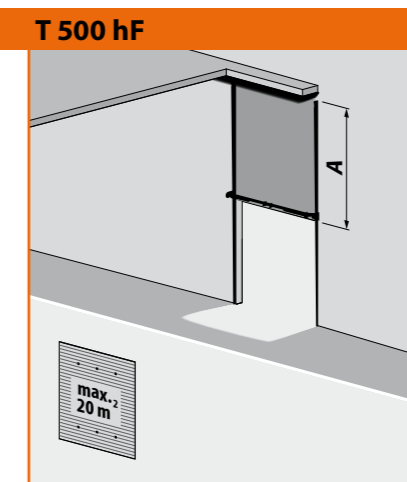
Pionowy system prowadnic z obniżonym wałem sprężynowym + stalowy profil wzmacniający
