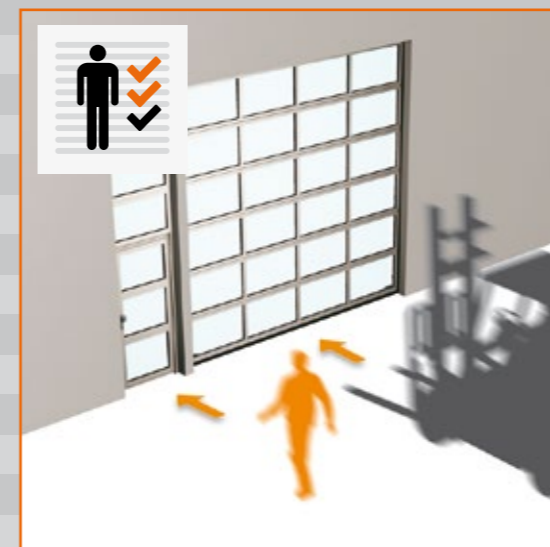
Oddzielenie drzwi dla ruchu osobowego i towarowego w tym samym otworze bramowym.
